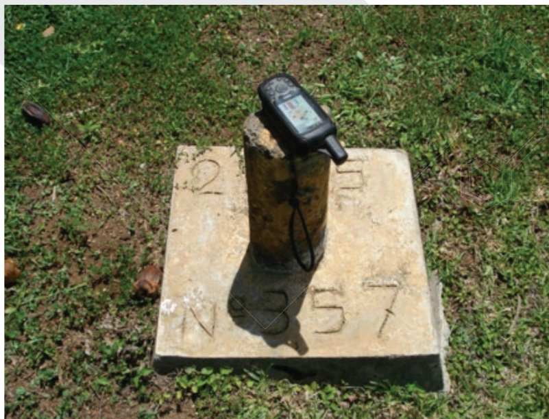
FIGURA 17. GPS UTILIZADO PARA GEOREFERENCIAR UN MOJÓN QUE DELIMITA LA ZONA PÚBLICA DE LA ZONA MARÍTIMO TERRESTRE.
