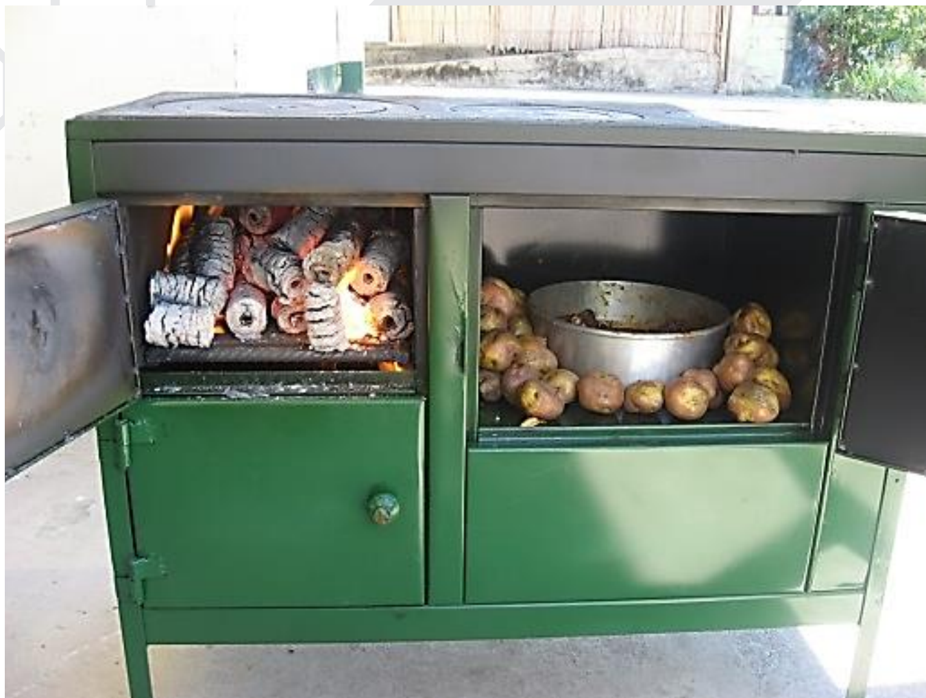
FIGURA 11: USO DE BRIQUETAS EN COCINAS MEJORADAS COMO UNA NUEVA OPORTUNIDAD DE UN PRODUCTO DE MAYOR VALOR AGREGADO.
