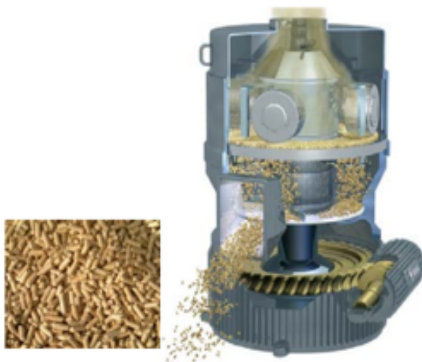
FIGURA 2. MECANISMO DE FUNCIONAMIENTO DE UNA PELETIZADORA.
