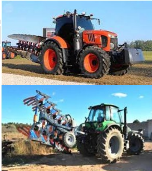
FIGURA 43: TRANSFERENCIA DE PESO AL EJE TRASERO POR ENGANCHE DE IMPLEMENTO PESADO.
