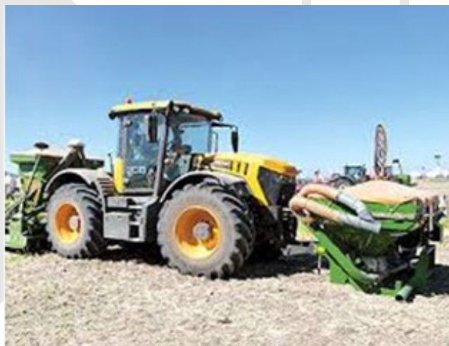
FIGURA 28: TRACTOR CON DISTRIBUCIÓN DE PESO SIMILAR EN AMBOS EJES CARGANDO IMPLEMENTOS EN ENGANCHES TRASERO Y DELANTERO.
