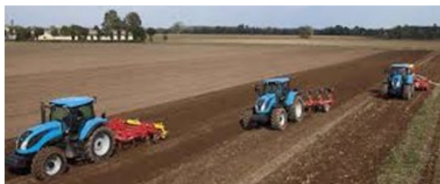
FIGURA 50: EQUIPO DE TRES TRACTORES HACIENDO LABORES DE LABRANZA PRIMARIA, SECUNDARIA Y AFINADO DE CAMA DE SIEMBRA.
