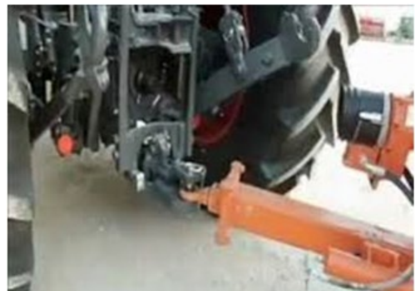
FIGURA 27: TIMÓN DE IMPLEMENTO CONECTADO A BARRA DE TIRO DE TRACTOR.
