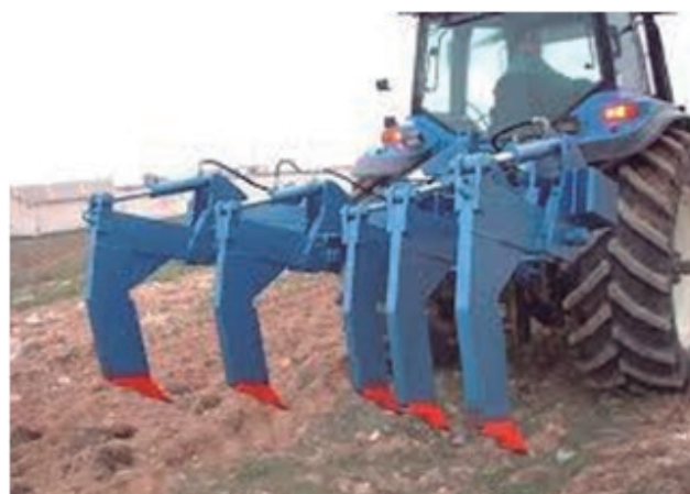
FIGURA 13: SUBSOLADOR DE 5 VÁSTAGOS CON FUSIBLE DE PROTECCIÓN DE TIPO HIDRÁULICO.
