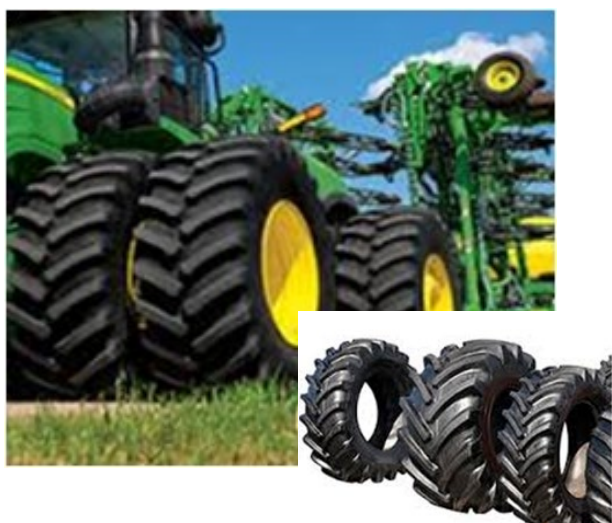
FIGURA 23: LLANTAS AGRÍCOLAS ANCHAS DE TIPO DE FLOTACIÓN.
