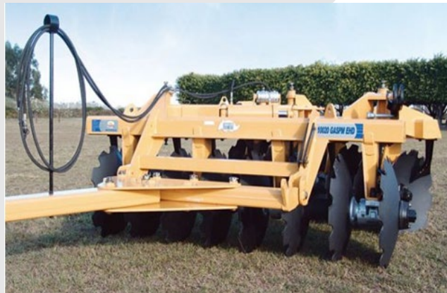
FIGURA 54: MARCO DE RASTRA ROMPEDORA DE TIPO PESADO.
