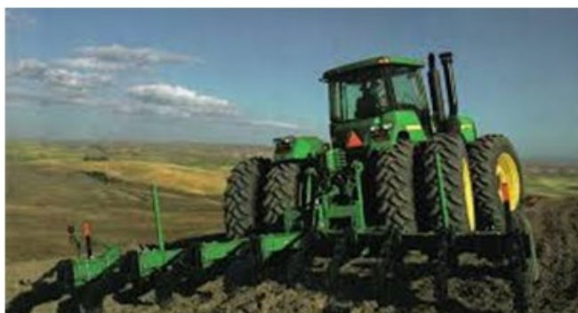
FIGURA 68: SUBSOLADOR COMPATIBLE CON TRACTOR DE LLANTAS DUALES PARA MEJORAR TRACCIÓN.
