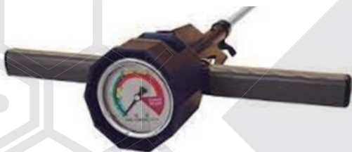
FIGURA 11: PENETRÓMETRO DE ACCIONAMIENTO POR PRESIÓN DEL PERFIL DE SUELO.
