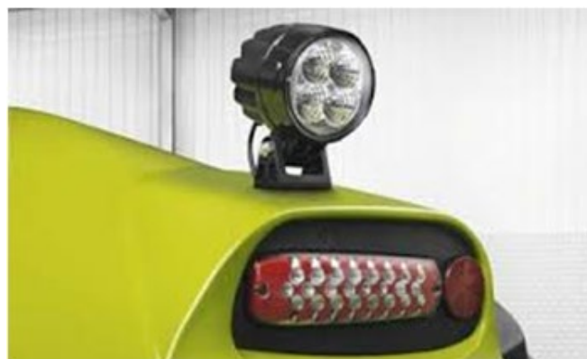
FIGURA 36: LUCES DE CIRCULACIÓN EN GUARDABARRO TRASERO DERECHO DE TRACTOR.
