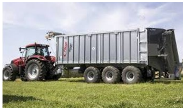
FIGURA 56: CARRETA DE TRANSPORTE DE TRES EJES ACOPLADA A TRACTOR. PARA ESTAS DIMENSIONES DE CARRETA ES NECESARIO QUE EL REMOLQUE ESTE EQUIPADO CON SISTEMA DE FRENOS SINCRONIZADO AL TRACTOR.
