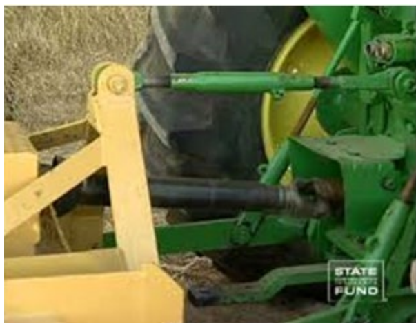
FIGURA 60: CONEXIÓN TÍPICA DE IMPLEMENTO AL ENGANCHE DE TRES PUNTOS DEL TRACTOR ACCIONADO POR TOMA DE FUERZA.
