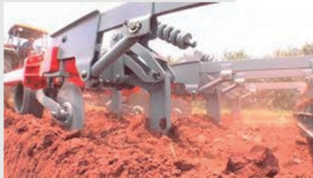
FIGURA 12: SUBSOLADOR ROMPIENDO EL PERFIL DE SUELO.
