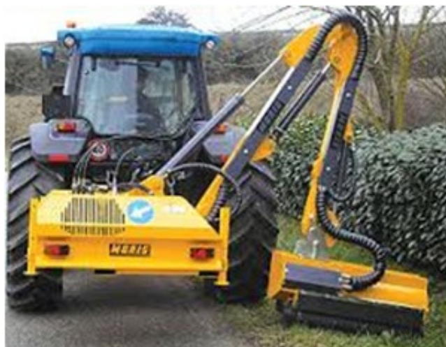
FIGURA 55: CHAPEADORA DE BRAZO ARTICULADO AL ENGANCHE DE TRES PUNTOS CON MOVIMIENTO HIDRÁULICO.
