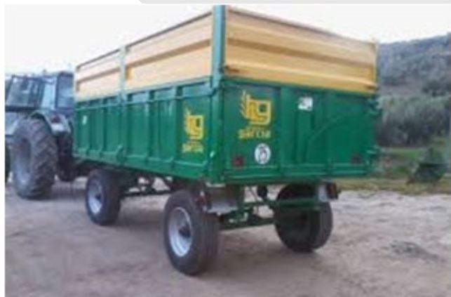
FIGURA. 35: REMOLQUE DE DOS EJES DE ENGANCHE A BARRA DE TIRO DE TRACTOR PARA TRANSPORTE EN CARRETERA.
