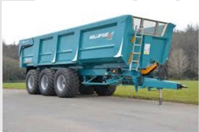
FIGURA 38: REMOLQUE DE TRANSPORTE DE GRANDES DIMENSIONES CON SEIS LLANTAS DE FLOTACIÓN PARA DISTRIBUCIÓN DE CARGA Y SISTEMA DE FRENOS.
