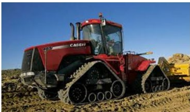
FIGURA 42: TRACTOR AGRÍCOLA ARTICULADO CON RODADO DE ORUGAS INDIVIDUALES.
