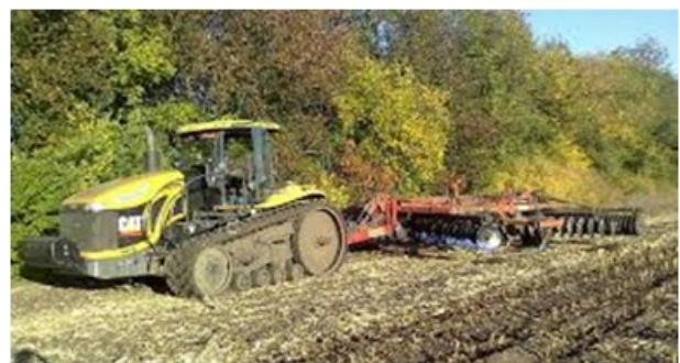
FIGURA 22: TRACTOR DE CARRILES DE APLICACIÓN ESPECIAL. CENTRO DE GRAVEDAD HACIA ADELANTE.
