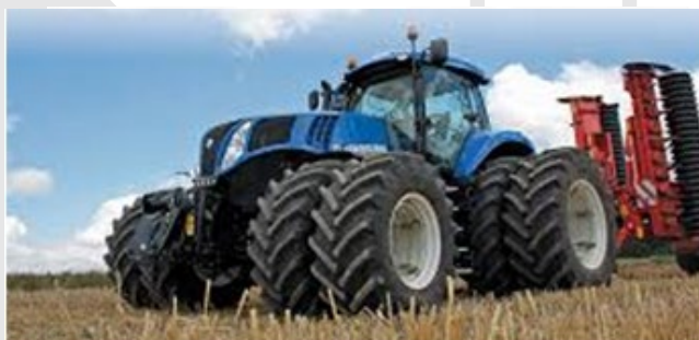
FIGURA 46: LLANTAS DOBLES EN AMBOS EJES PARA LABORES DE ALTA TRACCIÓN.
