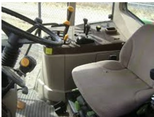
FIGURA 31: ASIENTO DE SEGURIDAD ÚNICO EN CABINA CERRADA DE TRACTOR.
