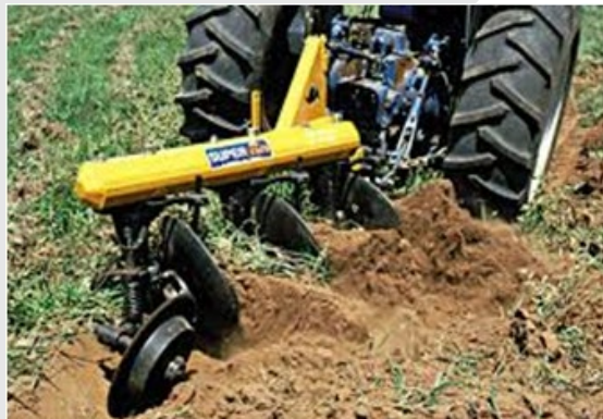
FIGURA 2: VOLTEO DE TERRENO CON ARADO DE DISCOS.
