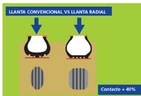
FIGURA 48: EFECTO DE LA REDUCCIÓN DE PRESIÓN DE INFLADO EN LLANTA RADIAL. LLANTA RADIAL SE DEFORMA A BAJA PRESIÓN BAJO CARGA SIN SUFRIR DAÑO ESTRUCTURAL.
