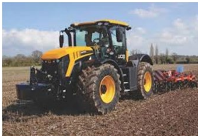
FIGURA 20: TRACTOR AGRÍCOLA CON 4 LLANTAS IGUALES Y CABINA CENTRADA. DISTRIBUCIÓN DE PESO 50% A 50%.
