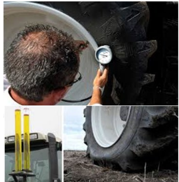
FIGURA 40: BAJA PRESIÓN DE INFLADO AUMENTA EL ÁREA DE CONTACTO DE LA LLANTA CON EL SUELO.
