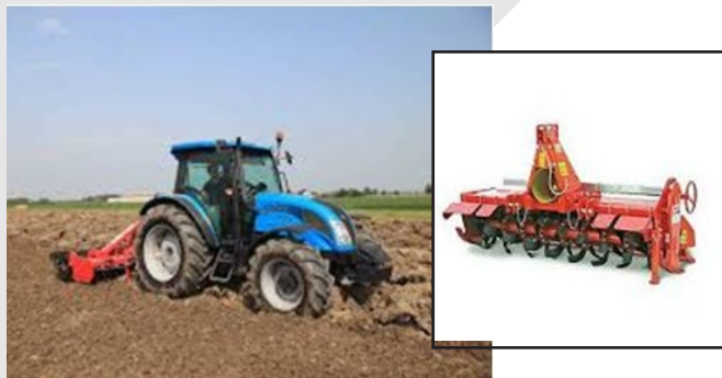
FIGURA 7: ROTOCULTIVADOR PARA AFINADO DE GRANULOMETRÍA DEL SUELO.
