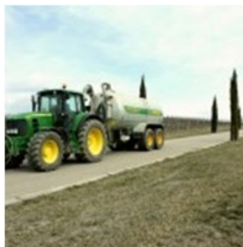
FIGURA 32: TRACTOR EN LABOR DE REMOLQUE DE TANQUE BOÑIGUERO POR CARRETERA.
