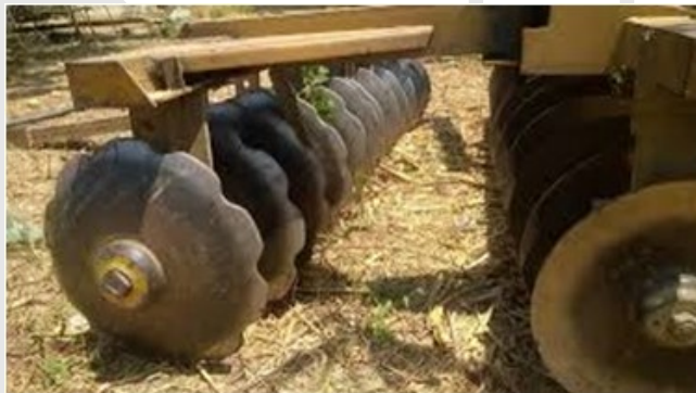
FIGURA 52: CUERPO DE DISCOS DE RASTRA. SE MUESTRA EL DESGASTE DE LOS DISCOS ESCOTADOS POR EL USO NORMAL.
