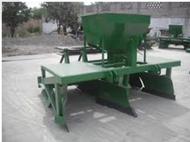
FIGURA 17: ENCAMADORA DE VERTEDERAS CON TOLVA PARA FERTILIZANTE.
