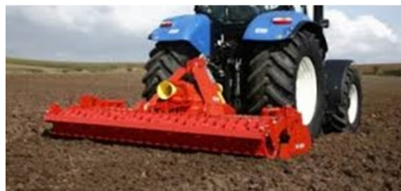
FIGURA 57: RASTRA ROTATIVA COMPATIBLE AL TRACTOR EN DIMENSIONES, PESO Y POTENCIA DE ACCIONAMIENTO REQUERIDA.
