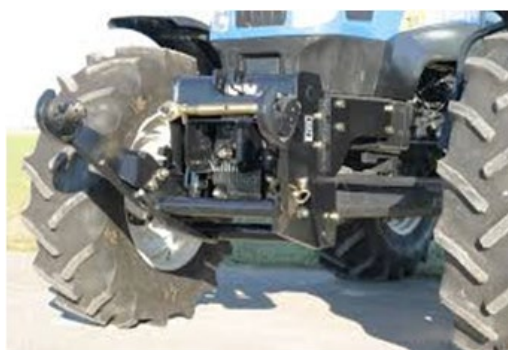
FIGURA 58: SISTEMA DE ENGANCHE DE TRES PUNTOS DELANTERO CON TOMA DE FUERZA.
