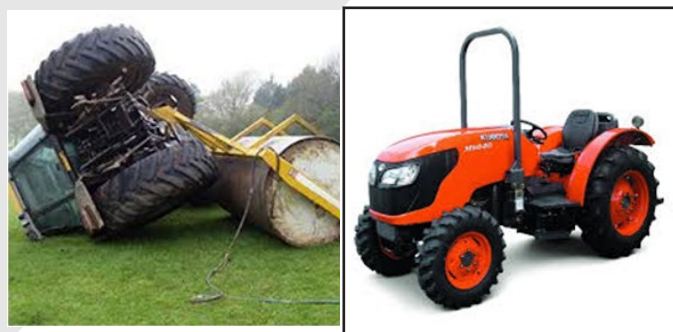
FIGURA 30: EL ARCO DE SEGURIDAD ROPS ES UNA ESTRUCTURA INDISPENSABLE PARA PROTEGER AL OPERARIO DE VOLCONAZOS.
