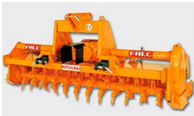
FIGURA 18: ROTOPUNTA PARA AFINAMIENTO DEL TERRENO AL ENGANCHE A LOS TRES PUNTOS Y ACCIONAMIENTO POR TOMA DE FUERZA.
