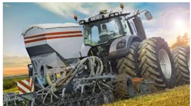
FIGURA 41: SISTEMA DE SIEMBRA COMPLETO CON REQUERIMIENTO DE ALTA TRACCIÓN (LLANTAS DOBLES).
