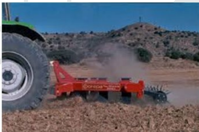
FIGURA 14: SUBSOLADOR DE MONTAJE AL ENGANCHE DE TRES PUNTOS CON RODILLO DESTERRONADOR TRASERO.
