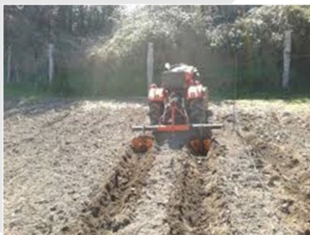
FIGURA 15: ENCAMADORA DE VERTEDERAS DE ENGANCHE A LOS TRES PUNTOS.
