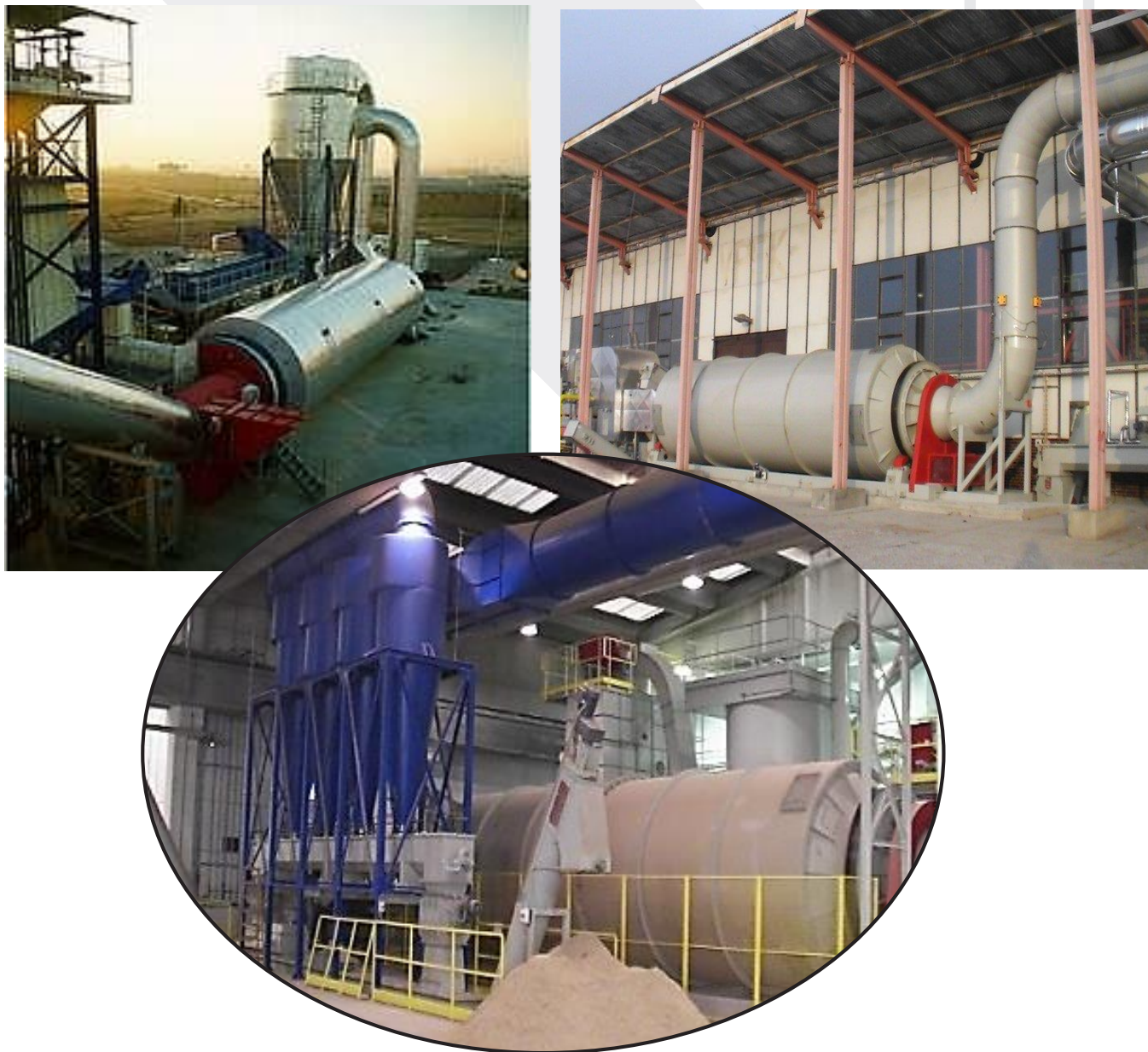
FIGURA 14: DIFERENTES TIPOS DE TAMBORES ROTATORIOS UTILIZADOS PARA EL SECADO DE LAS PARTÍCULAS DE BIOMASA.
