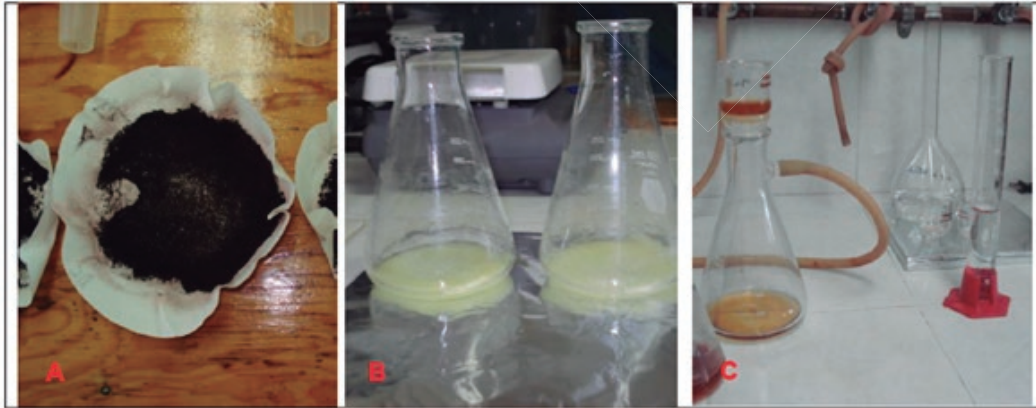
FIGURA 16: LIGNINA EN PAPEL FILTRO (A), PROCESO DE OBTENCIÓN DE HOLOCELULOSA (B) Y FILTRADO AL VACÍO DE ALFA-CELULOSA (C).
