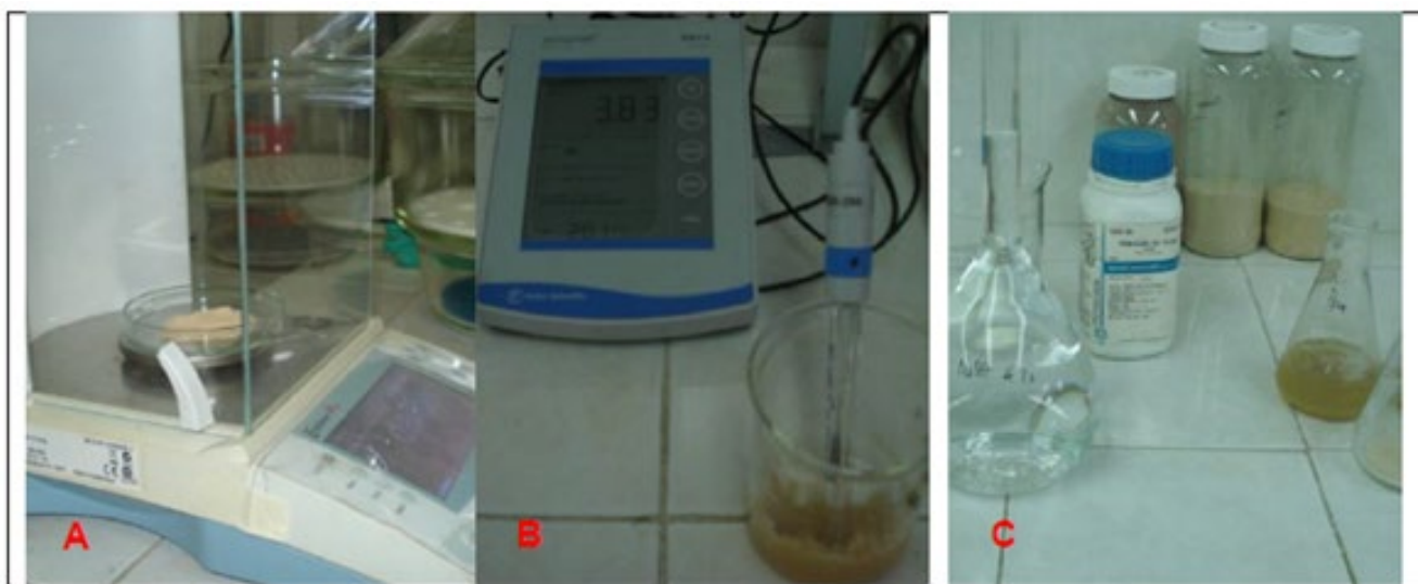
FIGURA 11: OBTENCIÓN DE PESO PARA DETERMINAR LA HUMEDAD (A), POTENCIÓMETRO PARA OBTENER VALOR DE PH (B), PROCESO PARA DETERMINAR SOLUBILIDAD A LA SOSA (C).
