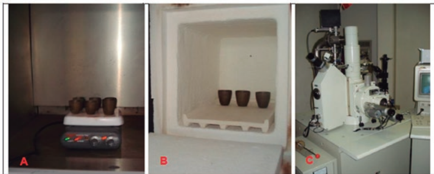
FIGURA 13: HARINA DE MADERA EN CRISOLAS DE NÍQUEL SOBRE PLACA DE CALENTAMIENTO (A), CRISOLAS DENTRO DE MUFLA PARA OBTENCIÓN DE CENIZAS (B) Y MICROSCOPIO DE BARRIDO PARA MICROANÁLISIS DE CENIZAS (C).
