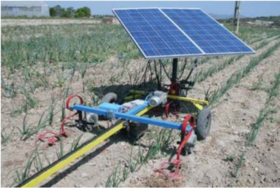
FIGURA 20. ARADOR SOLAR. NO COMPACTA LA TIERRA Y TRABAJA DE MANERA RÁPIDA Y EFICIENTE CON ENERGÍA DEL SOL.
