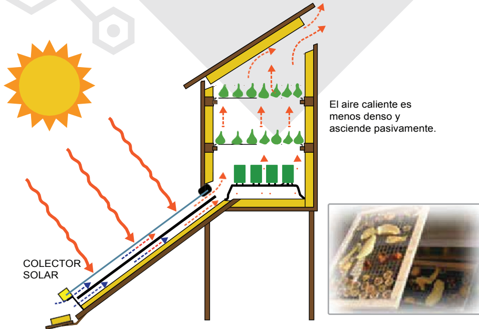
FIGURA 17. FUNCIONAMIENTO BÁSICO DE UN SECADOR TÉRMICO SOLAR.
