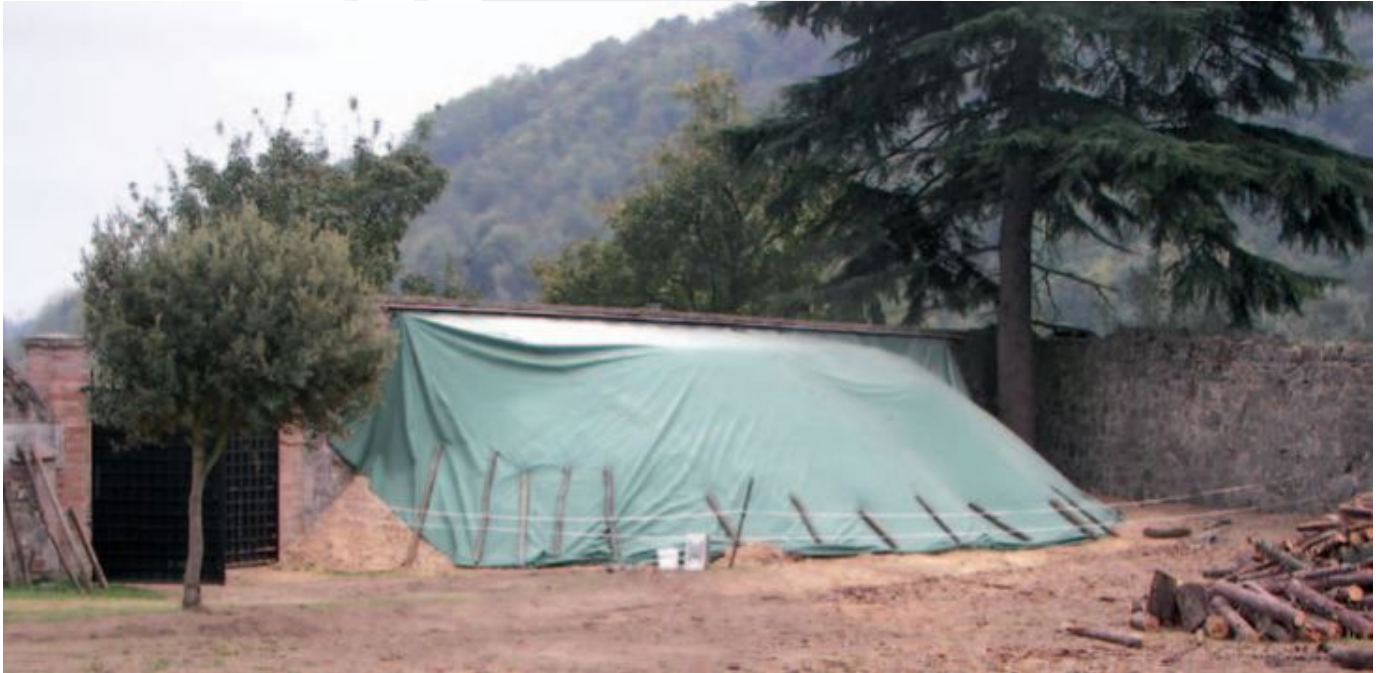
FIGURA 48. EMPLEO DE LONAS DE PROTECCIÓN DE MATERIAL ESPECIAL PARA EL SECADO DE LAS ASTILLAS.
