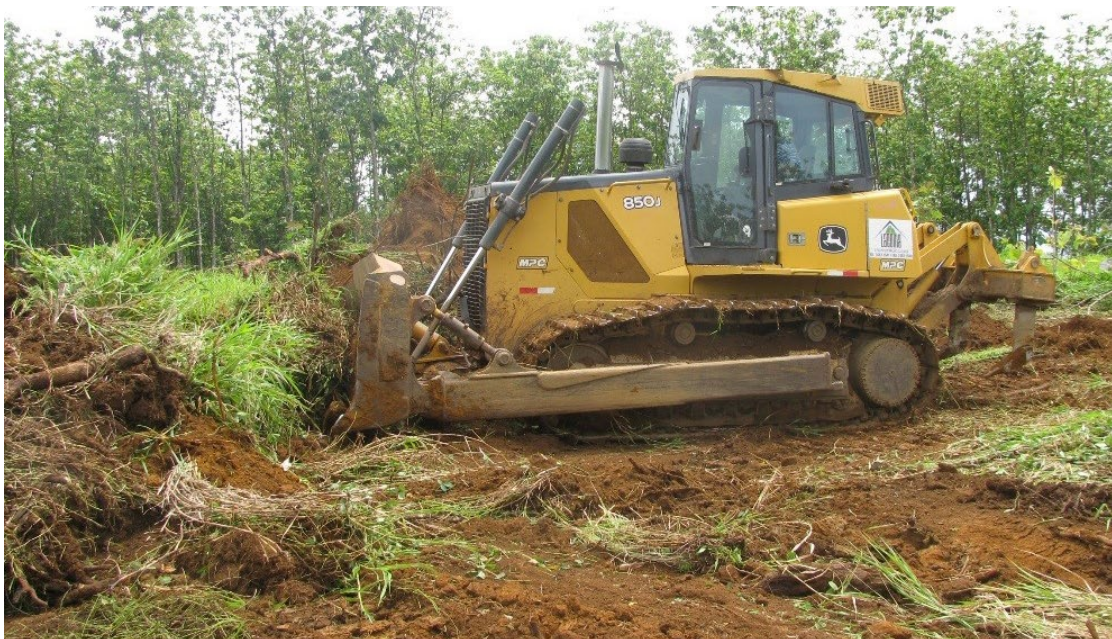
FIGURA 16. TRACTOR DE ORUGA REALIZANDO ACTIVIDADES DE ELIMINACIÓN DE MALEZA Y LIMPIEZA DEL TERRENO PARA EL ESTABLECIMIENTO DE PLANTACIONES DENDROENERGÉTICAS
