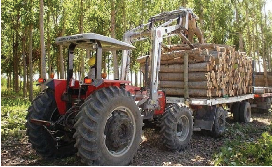
FIGURA 40. SISTEMA SIMPLIFICADO DE CORTA Y CARGA DE MADERA PARA EL TRANSPORTE A UNA CORTA DISTANCIA Y SU ACOPIO.
