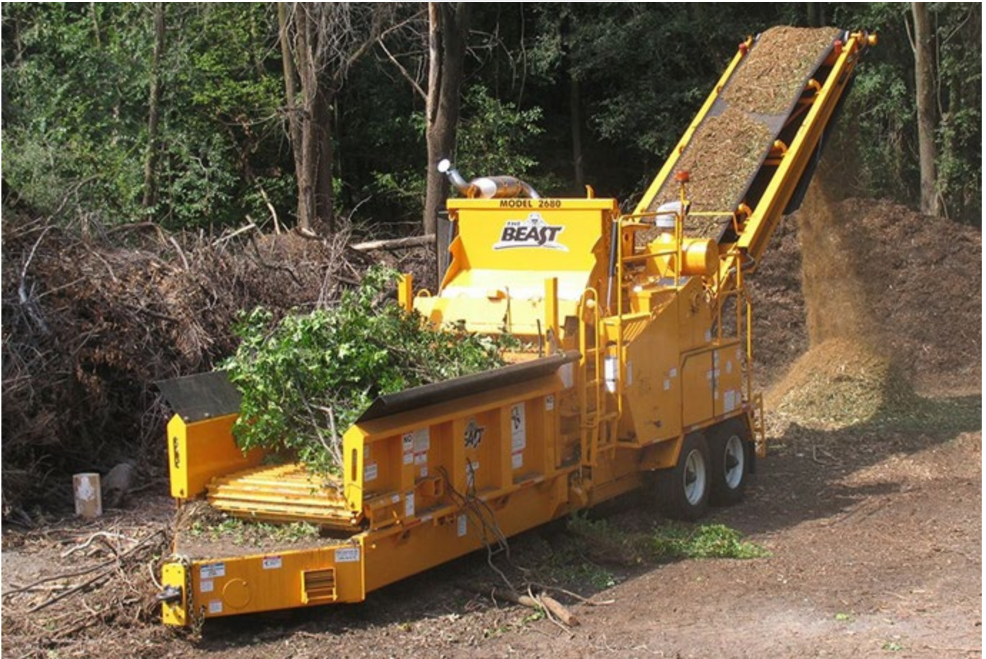
FIGURA 45. EQUIPO DE ASTILLADO BANDIT BEAST 2680 DE HASTA 540 CV Y HASTA 56 T/H ES UN EQUIPO MUY POTENTE Y FÁCIL DE TRANSPORTE, UTILIZADO EN ALGUNOS PAÍSES DE CENTROAMÉRICA.
