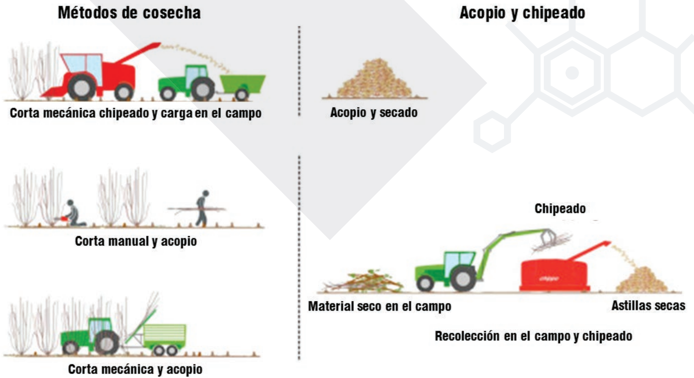
FIGURA 35. DIAGRAMA DE POSIBILIDADES PARA EL APROVECHAMIENTO, APILADO, ASTILLADO CARGA Y TRANSPORTE DE LA BIOMASA
