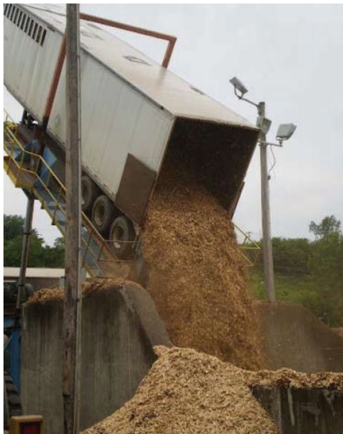
FIGURA 53. SISTEMAS DE DESCARGA EN LA INDUSTRIA Y QUE OPTIMIZA LA LABOR DE TRANSPORTE DE LAS ASTILLAS
