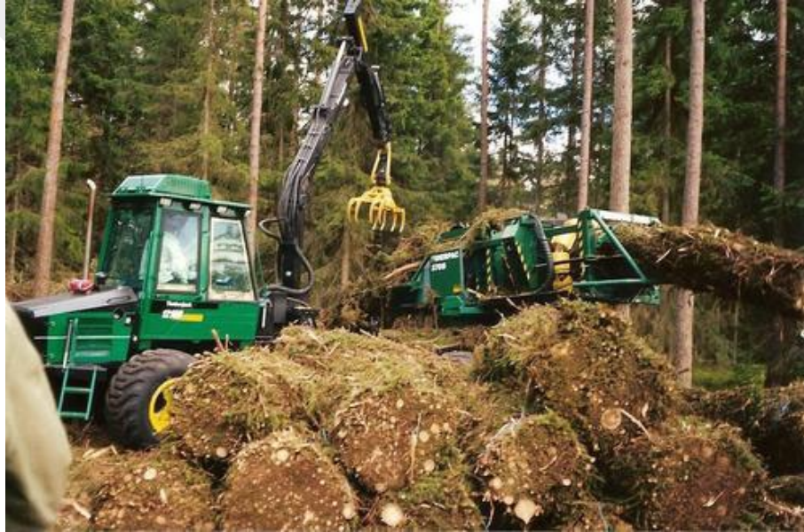
FIGURA 46. EQUIPO DE EMPACADO DE RESIDUOS FORESTALES PARA SU RECOLECCIÓN Y TRANSPORTE POSTERIOR
